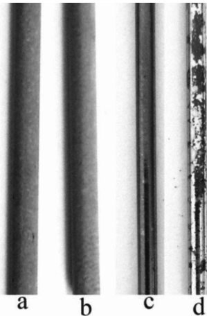
Рис. 1. Внешний вид тестируемых образцов: а – КФМДО перед началом эксперимента, б – КФМДО через 28 сут после инкубации в растворе электролита, с – КФВЧМР перед началом эксперимента, d - КФВЧМР через 28 сут после инкубации в растворе электролита.
